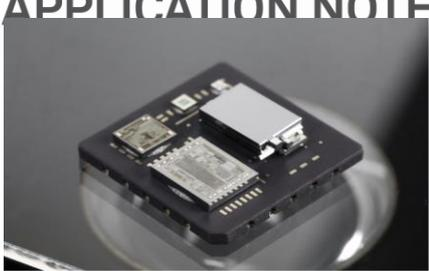
它采用单电源电压（在 2.5V~5.5V 之间），与低电流消耗（在 5V 电压时，小于 0.5mA）。在输入 5V 电压条件下，其输出是一个成比例的模拟电压，在全量程范围内，输出值在 0.5V~4.5V 之间变化。该传感器是一个独立的，采用 20 引脚 LCC 陶瓷封装，以确保产品的全密封性。产品在 -55°C~125°C 温度范围内工作，并能承受高达 6000g 的冲击。其零偏长期稳定性和标度因数通常小于全测量范围的 0.1 %。
