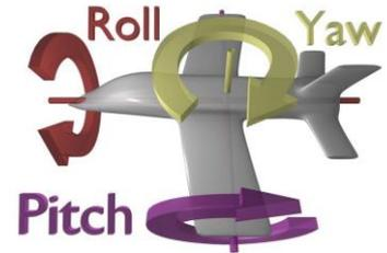
AHRS 是设计来取代传统的机械陀螺飞行仪表，并能提供卓越的可靠性和准确性。它由三个轴向上的固态或 MEMS（微机电系统）陀螺仪，加速度传感器和磁强计组成。一些 AHRS 使用 GPS 接收机，以改善陀螺仪的长期稳定性。人们通常使用卡尔曼滤波器来计算这些多个来源的结果。
